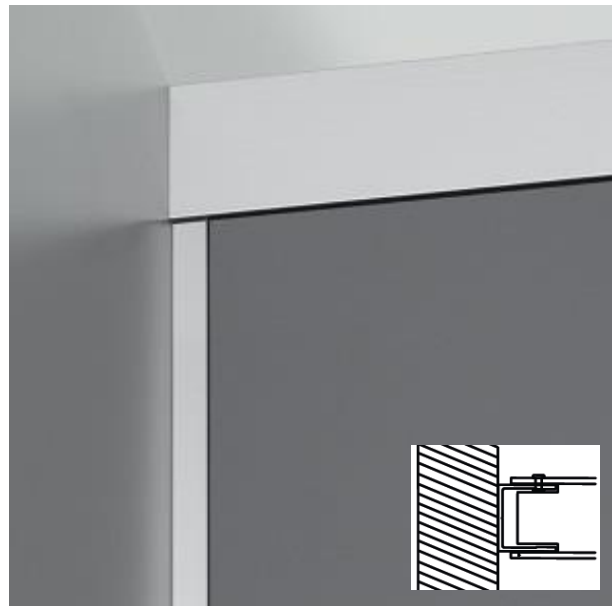
Maueranschlüsse durch Schattenfugen zum Ausgleich von Bautoleranzen
